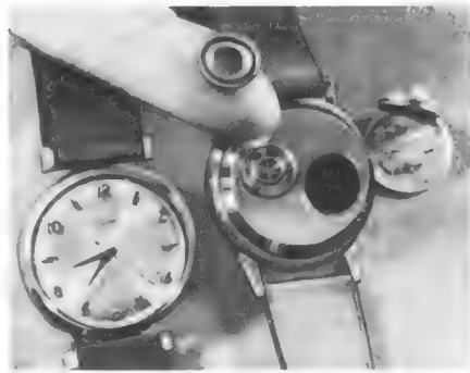
Bild 1. Armbanduhr mit Transistor-Antrieb. Rechts die geöffnete Rückseite der Uhr beim Auswechseln der Batterie. Die auf der Fingerkuppe sichtbare Batteriezelle hält die Uhr 12 Monate im Betrieb
